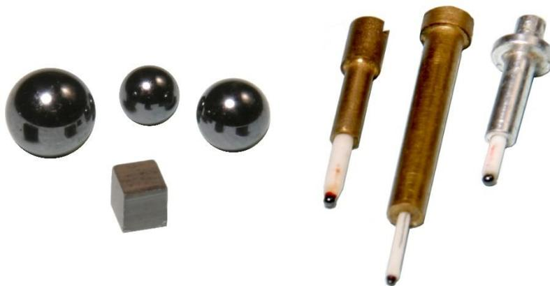
ЖИГ-резонаторы производства АО «НИИ «Феррит-Домен» обладают высокой добротностью, узкой шириной кривой ферромагнитного резонанса, высокой температурной стабильностью и могут функционировать в широком диапазоне частот - от октавы до мультиоктавы.
